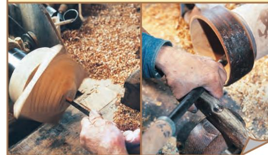
④磨き（回転している材料の表面を、紙ヤスリで磨いて滑らかにします。）
