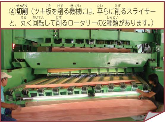
④切削（ツキ板を削る機械には、平らに削るスライサー
