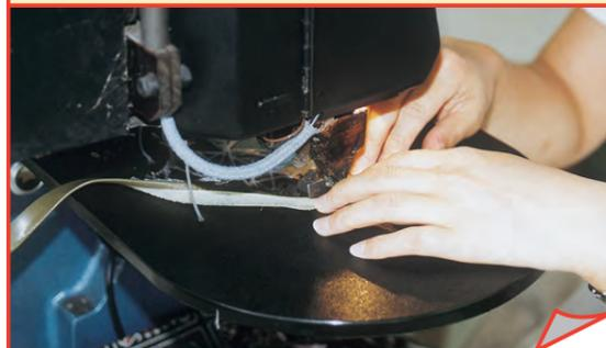
⑤吊り込み（靴のアッパーを足型にかぶせて、底にあたる部分を吊り込みます。）
