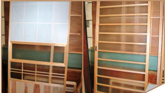
⑧組み立て (加工したそれぞれの材料に、接着剤を塗って組み立てます。)
