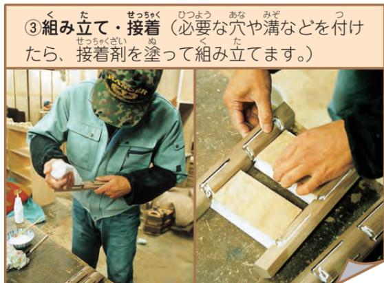
③組み立て・接着（必要な穴や溝などを付けたら、接着剤を塗って組み立てます。）
