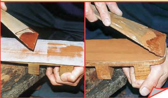
③錆付け(錆を付け、乾いたら磨くという作業を2~3回繰り返します。)
