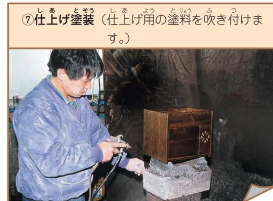
⑦仕上げ塗装（仕上げ用の塗料を吹き付けます。）
