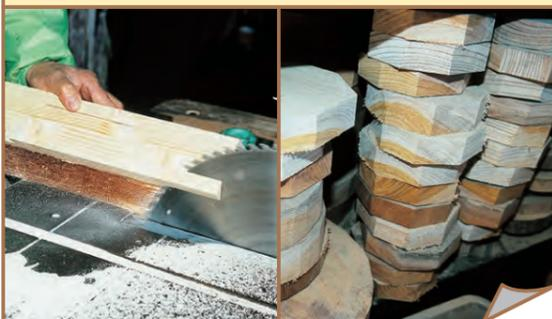
②③木を削る（材料を回転させて、専用の刃物で削ります。刃物はすべて職人さんの手作りです。）
