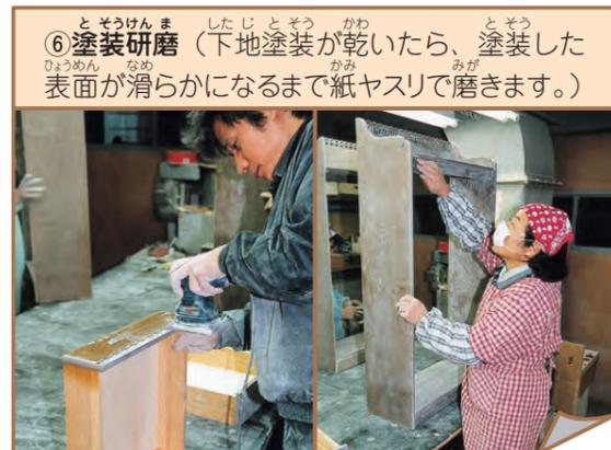
⑥塗装研磨（下地塗装が乾いたら、塗装した表面が滑らかになるまで紙ヤスリで磨きます。）
