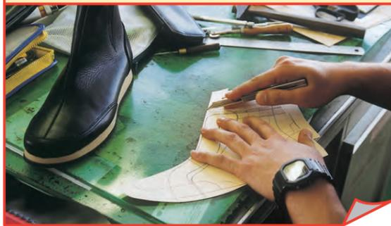
②裁断（紙型をもとに金属の抜き型をつくり、裁断機で材料の皮を押し切ります。）
