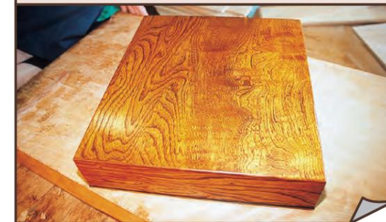
**⑧磨き**(蓋板を外枠にはめ込んで接着したら、紙ヤスリで磨いて仕上げます。)
