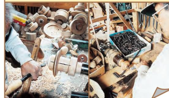
②③木を削る（テーブルの足や、階段の手すり飾りなど細長いものは、ダライ旋盤で材料を回転させて削ります。）
