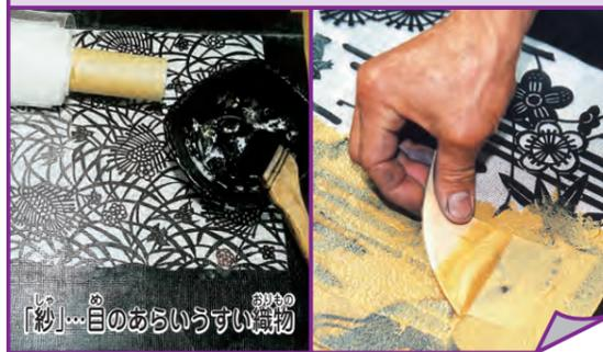
⑥中干し(かため)(本染めに備えて糊を丈夫にするため、生地を藍がめに浸したら乾燥させます。)
